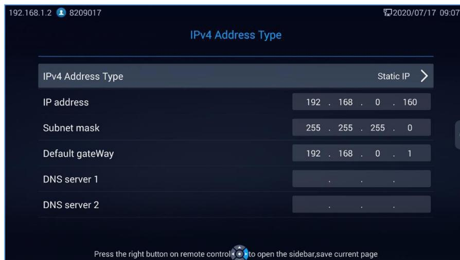
図19: IPv4 設定 – Static IP(静的IP)
